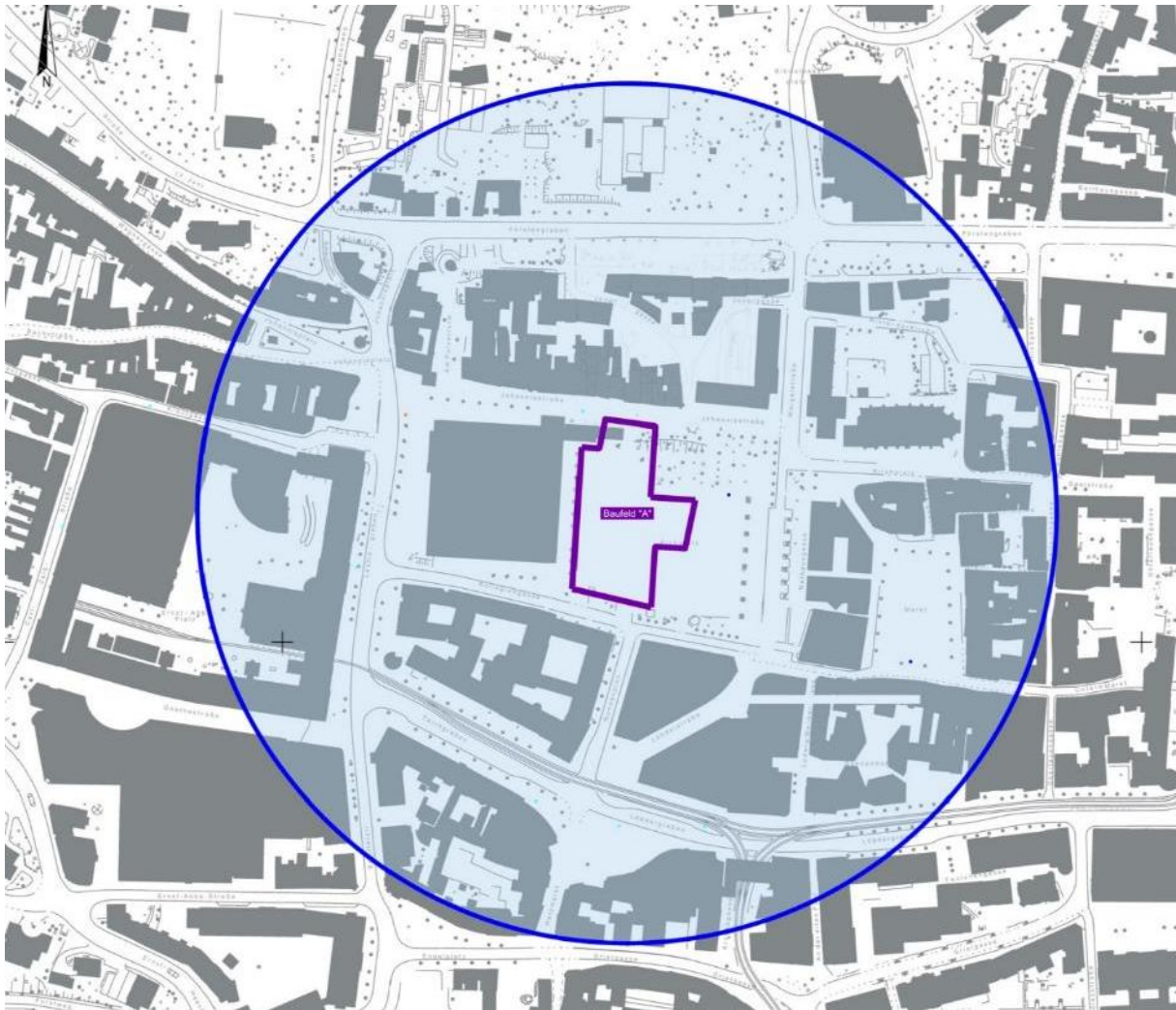
Abbildung 7: Prognostische Reichweite des Absenkebeckens der Bauwasserhaltung
