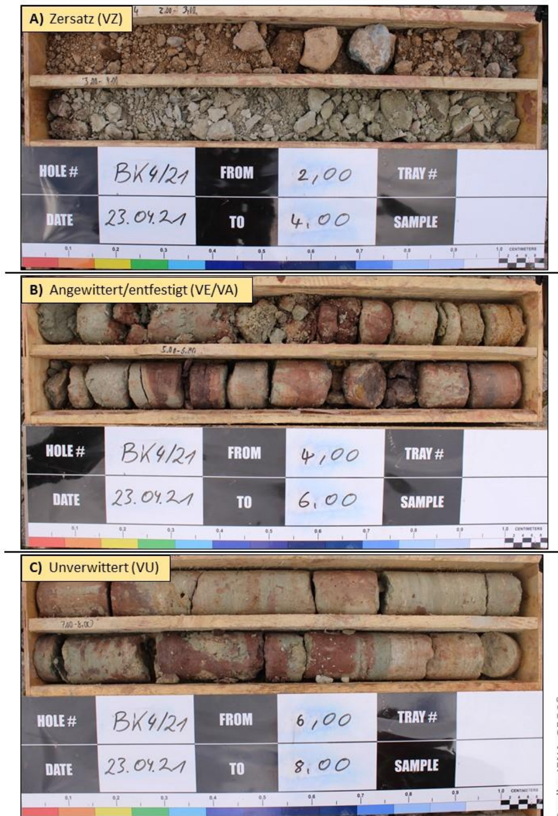
Abbildung 4: Bohrkernsektionen der Bohrung KB 4/21 (GWM 1/21), die exemplarisch die Verwitterungsgrade der Gesteine des Buntsandsteins zeigen.
