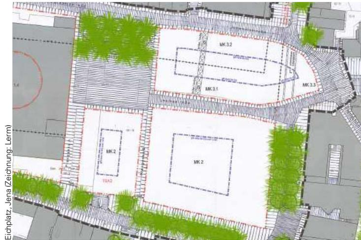
Belagsstruktur quer zur Hauptbewegungsrichtung. Bei Platzflächen klären, wo Hauptbewegungsrichtungen liegen und die Belagsrichtung entsprechend anordnen
